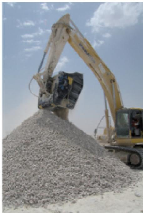
et des techniciens MB. La nouvelle version du godet concasseur est en effet plus résistante pendant les travaux, elle se caractérise par son encombrement limité et possède une meilleure structure qui facilite la manoeuvrabilité sur l'excavateur.
