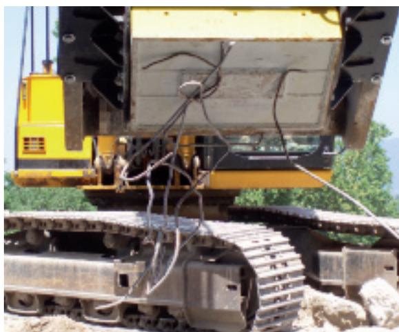
■ **IL DEFERRIZZATORE applicato sulla benna frantoio separa direttamente in cantiere il ferro che si trova all'interno del materiale frantumato.**
