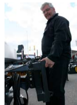
SOPPBORSTE MED VATTENTANK. Ysta Maskiner har tagit fram en komplett sopborste med vattentank och hydrauliskt driven sidoborste för priset 52 000 kronor. Den är 1,5 meter bred och klarar sig med 1 dubbelverkande uttag på traktorn.
