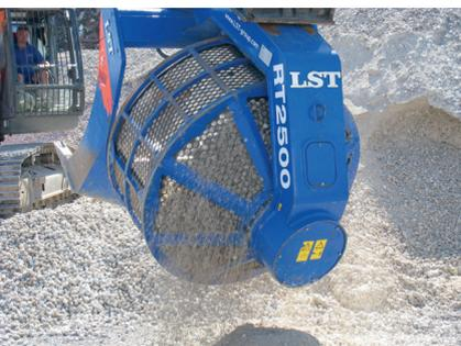
**Der rotierende LST Baggeranbau-Sieblöffel RT 2500**
