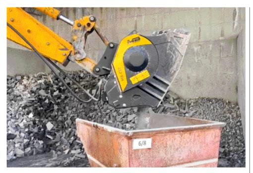
iccola, maneggevole ed estremamente compatta, la benna frantoio MB-C50 per escavatori e terne che vanno da 65 a 100 quintali, è la più piccola della gamma di benne frantoio prodotta da MB Crusher. Questa versatile attrezzatura è diventata uno strumento imprescindibile per Italgraniti dei F.lli Latronico, una interessante realtà ubicata a Senise, provincia di Potenza,
