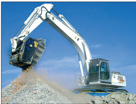
Las cucharas trituradoras para triturar en obra serán el eje del stand de MB .
