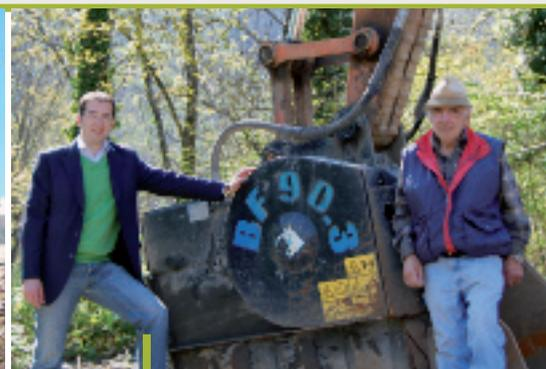
**La cava-deposito dell'impresa Marietta s.n.c. a Germagnano (TO) in cui viene macinato il materiale proveniente dagli scavi e demolizioni effettuati dall'impresa. Ridotto nella pezzatura omogenea scelta, il materiale viene rimesso in opera per sottfondi stradali, drenaggi, riempimenti, ecc. A destra, l'Hitachi 210 munito di benna da scavo.**
