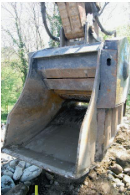
**La bocca che raccoglie il materiale è delimitata da due fianchi laterali, dalla parte inferiore con «tagliente», e dalla parte superiore destinata agli elementi che trasmettono il movimento: l'albero motore e i 2 volani per avere più inerzia. La pompa idraulica è collocata posteriormente.**
