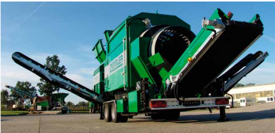
Die zwei Achsen im Abstand von 1.270 mm garantieren zusammen mit der optimalen Gewichtsverteilung und der Zwillingbereifung einen stabilen und sicheren Transport. | Foto: Zemmler
