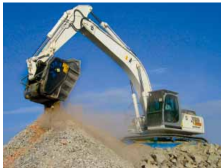
Mit MB wird der Bagger zum Brecher – dank Enteisener jetzt mit noch besseren Resultaten. | Foto: MB
