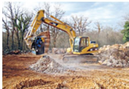
frantumazione. Il suo migliore assetto strutturale e il baricentro ricalcolato facilitano la manovrabilità dell'operatore. Invariato rimane il peso (3.500 kg), mentre cambiano la capacità di carico (0,80 m<sup>3</sup>), le dimensioni della benna (cm 215 x 135 x 145) e quelle dell'apertura della bocca (larghezza cm 90 e altezza cm 51). Migliora anche la produzione oraria, che con questo nuovo modello risulta essere
