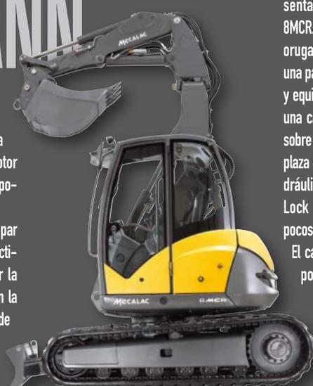
senta la nueva excavadora multifunción 8MCR. La 8MCR es un concepto de vehículo oruga que combina las características de una pala compacta de 7 toneladas con motor y equipamiento en la parte superior y las de una cargadora compacta rápida con chasis sobre orugas triangulados. La 8MCR se desplaza hasta 10 km/h. El enganche rápido hidráulico del equipamiento Mecalac, Active Lock permite cambiar de herramienta en pocos segundos, sin descender de la cabina.
