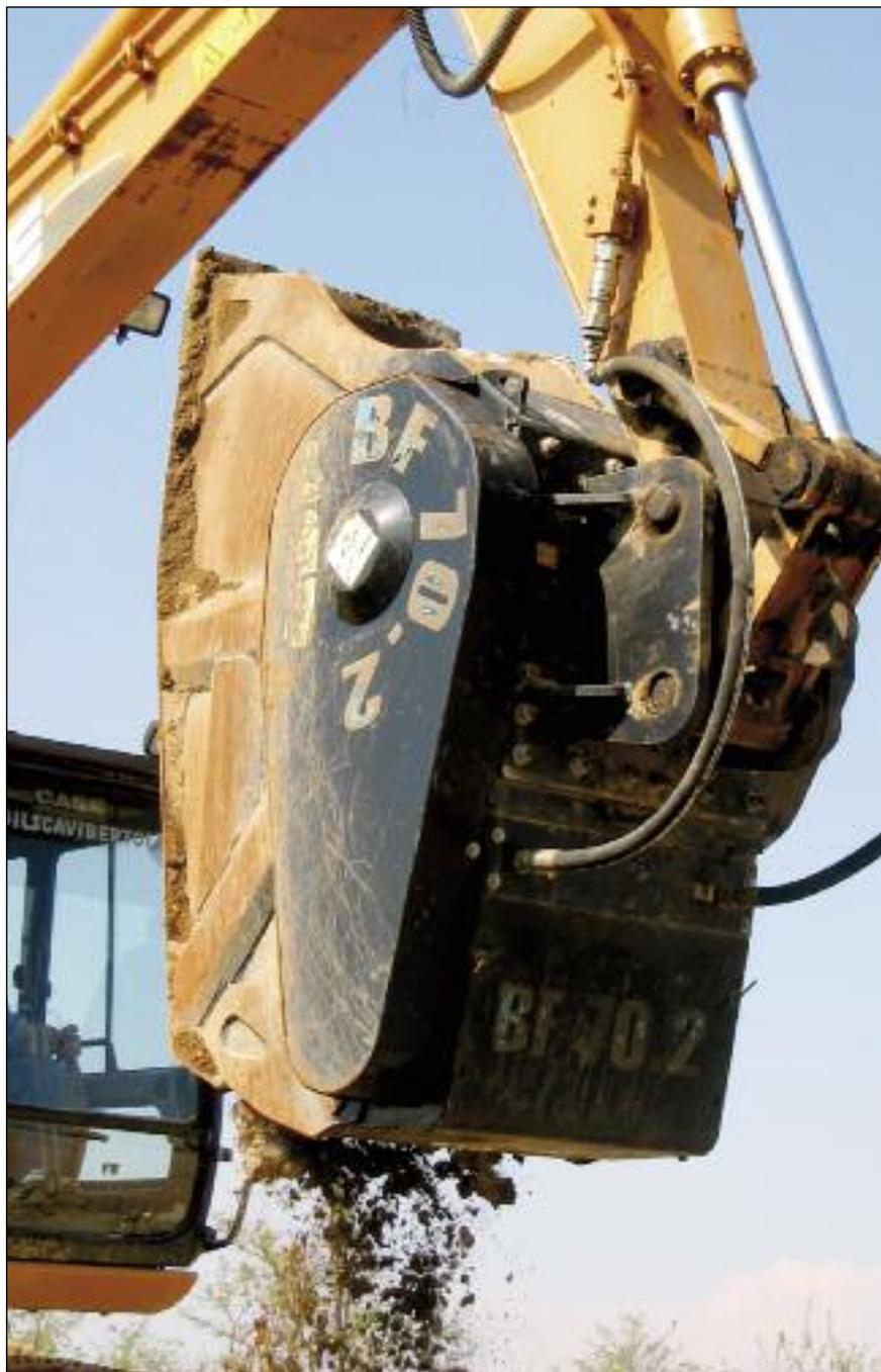
■ L'apertura delle mascelle fino ai 120 mm permette alla BF 70.2 di raccogliere materiali anche di ragguardevoli dimensioni, come i grossi pezzi di calcestruzzo che derivano da pilastri e pavimentazioni
