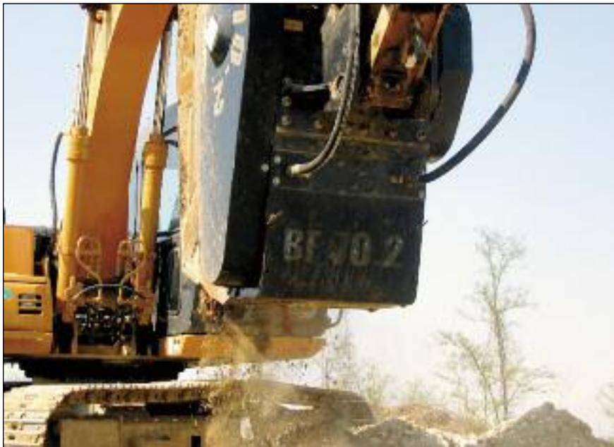
■ La benna BF in azione: ogni operazione di frantumazione viene semplificata dall'installazione dell'attrezzatura tramite l'impianto-martello dell'escavatore. Con un volano si attua il principio funzionale di un vero e proprio frantoio mobile
