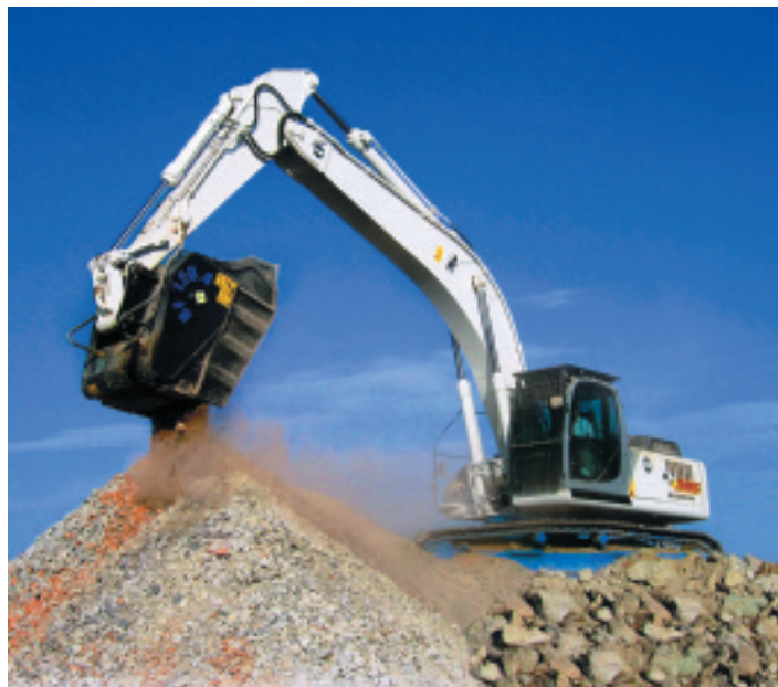
La gamme M B S.p.A. se décline en 4 godets concasseurs allant de 0,5 m 3 à 1 m 3 de volume de charge.
