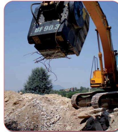
mento que antes no existía ya que la trituración y el reciclaje estaban reservadas a las máquinas dotadas de carro, orugas y motorizadas. Además, la polivalencia es alta y es suficiente una excavadora corriente, que las empresas grandes y pequeñas fácilmente tienen a disposición, para trabajar con eficacia.
