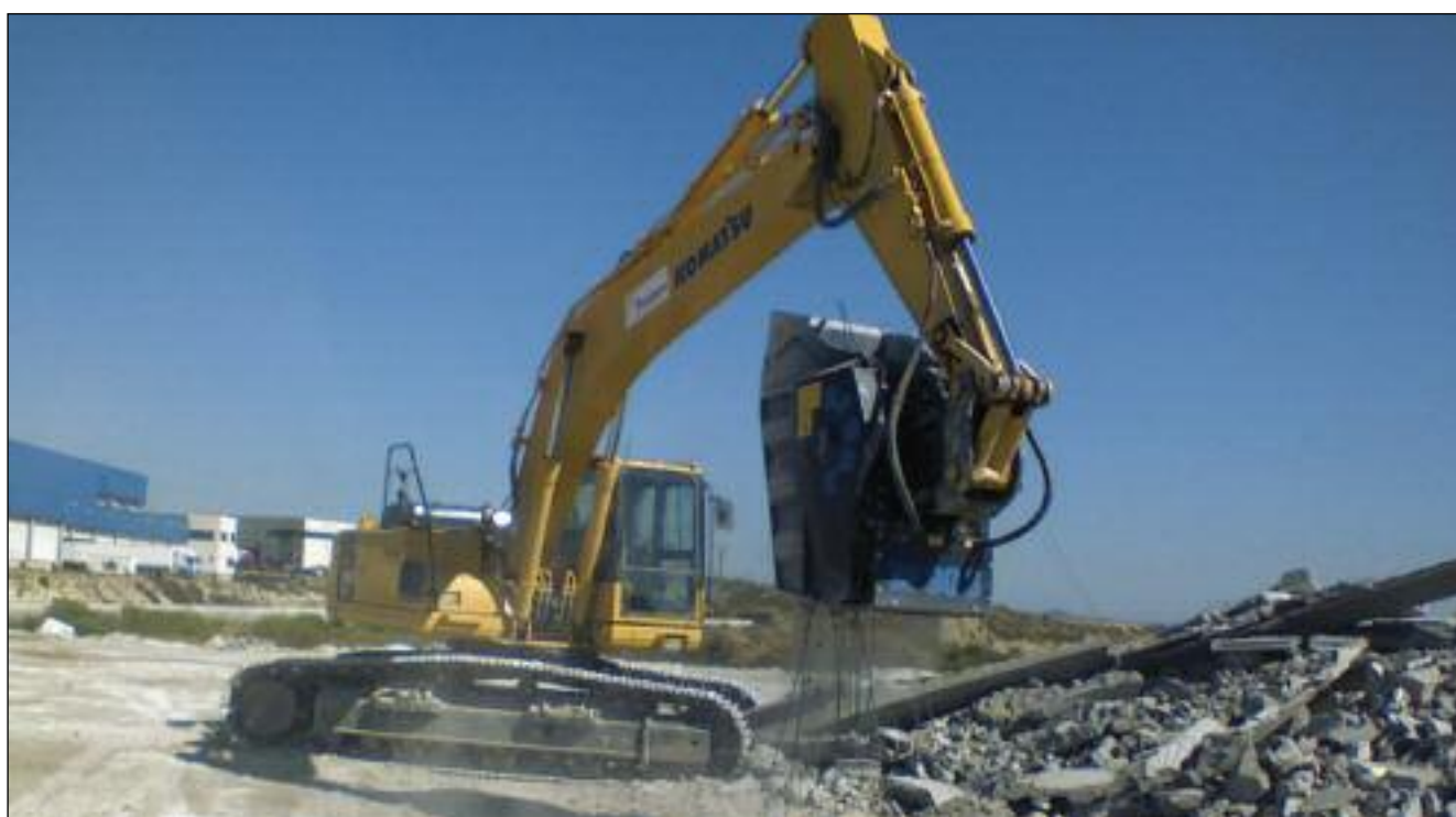
■ La BF 90.3 pesa 3,5 t, ha un'apertura della bocca da 90x45 cm e presenta un volume di carico di 0,75 m 3 , per una pezzatura in uscita da 20 a 120 mm
