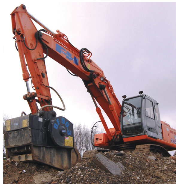
■ LA BENNA FRANTOIO BF 90.3 montata su un escavatore Fiat Hitachi Ex215.
