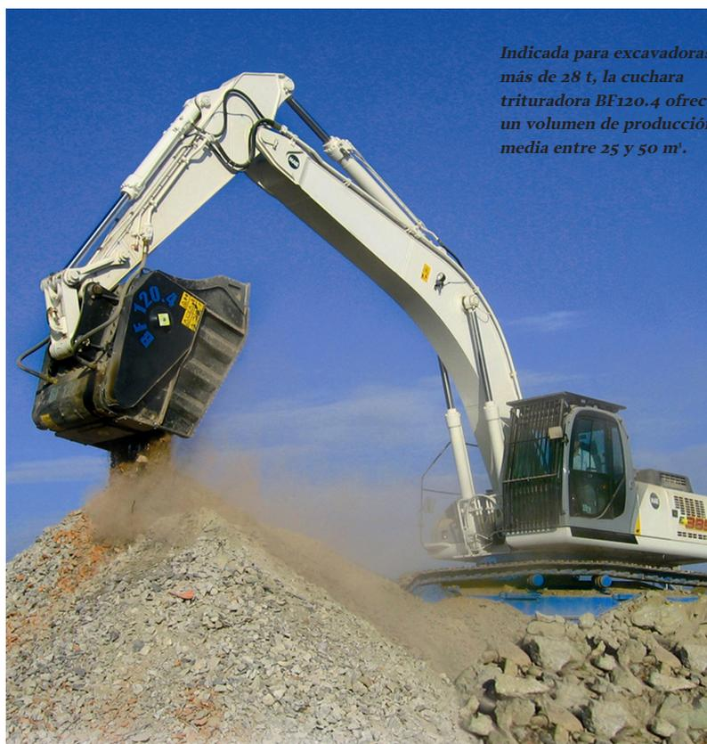
*Indicada para excavadoras más de 28 t, la cuchara trituradora BF120.4 ofrece un volumen de producción media entre 25 y 50 m<sup>3</sup>.*
