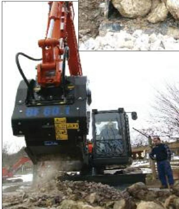
La benna frantoio MB modello BF 60.1 consente la riduzione sia dei costi sia dei tempi di trattamento del materiale di risulta da scavi tramite la riduzione volumetrica sul posto.
