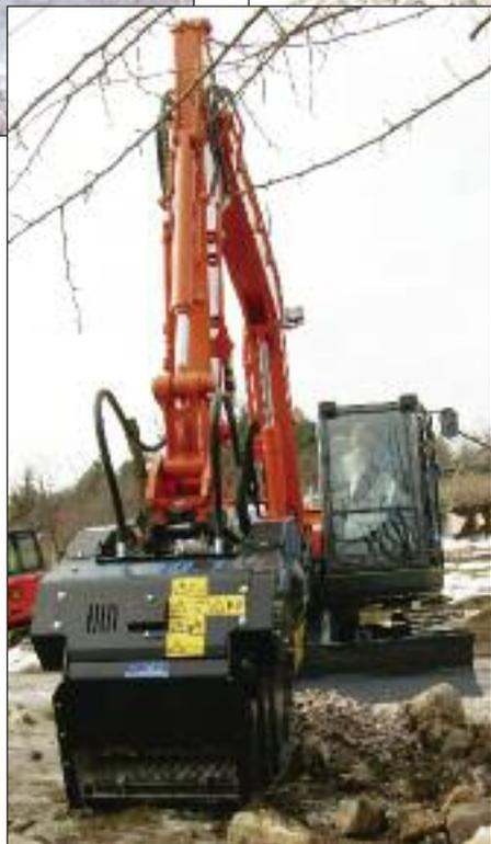
e le svariate prove sul campo hanno portato alla scelta e alla preparazione della macchina ideale alla quale affiancare la BF 60.1, modello che si adatta ad escavatori con peso dalle 8 alle 14 tonnellate.
