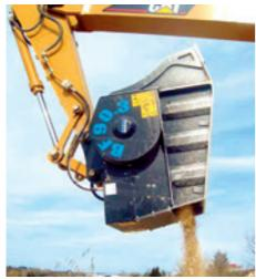
tonnellate ed è consigliata per escavatori dalle 8 alle 12 tonnellate. L'apertura della bocca misura 60x45 cm e il volume di carico è pari a 0,5 m³.
