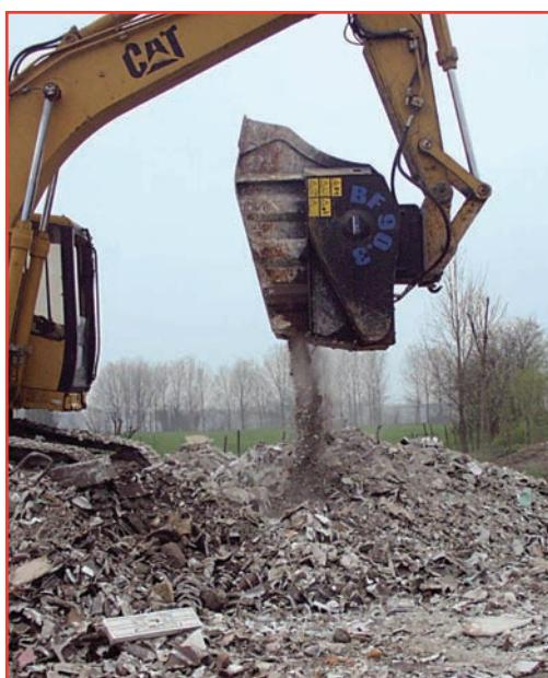
comparecer en el mercado y abrir un segmento de mercado que antes no existía (la trituración y el reciclaje estaban reservadas a las máquinas dotadas de carro, orugas y motorizadas). Además, la polivalencia es alta y es suficiente una excavadora corriente, que las empresas grandes y pequeñas fácilmente tienen a disposición, para trabajar con eficacia.
