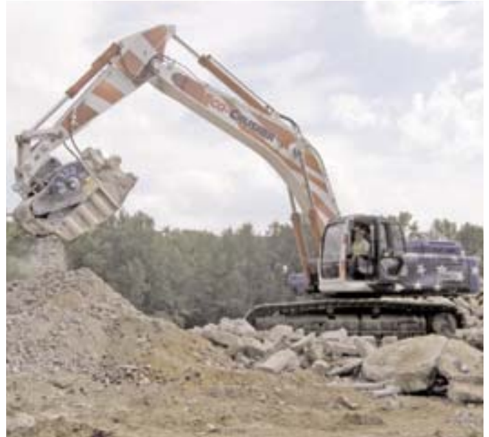
Der Backenbrecherlöffel von MB im Einsatz beim amerikanischen Militär
