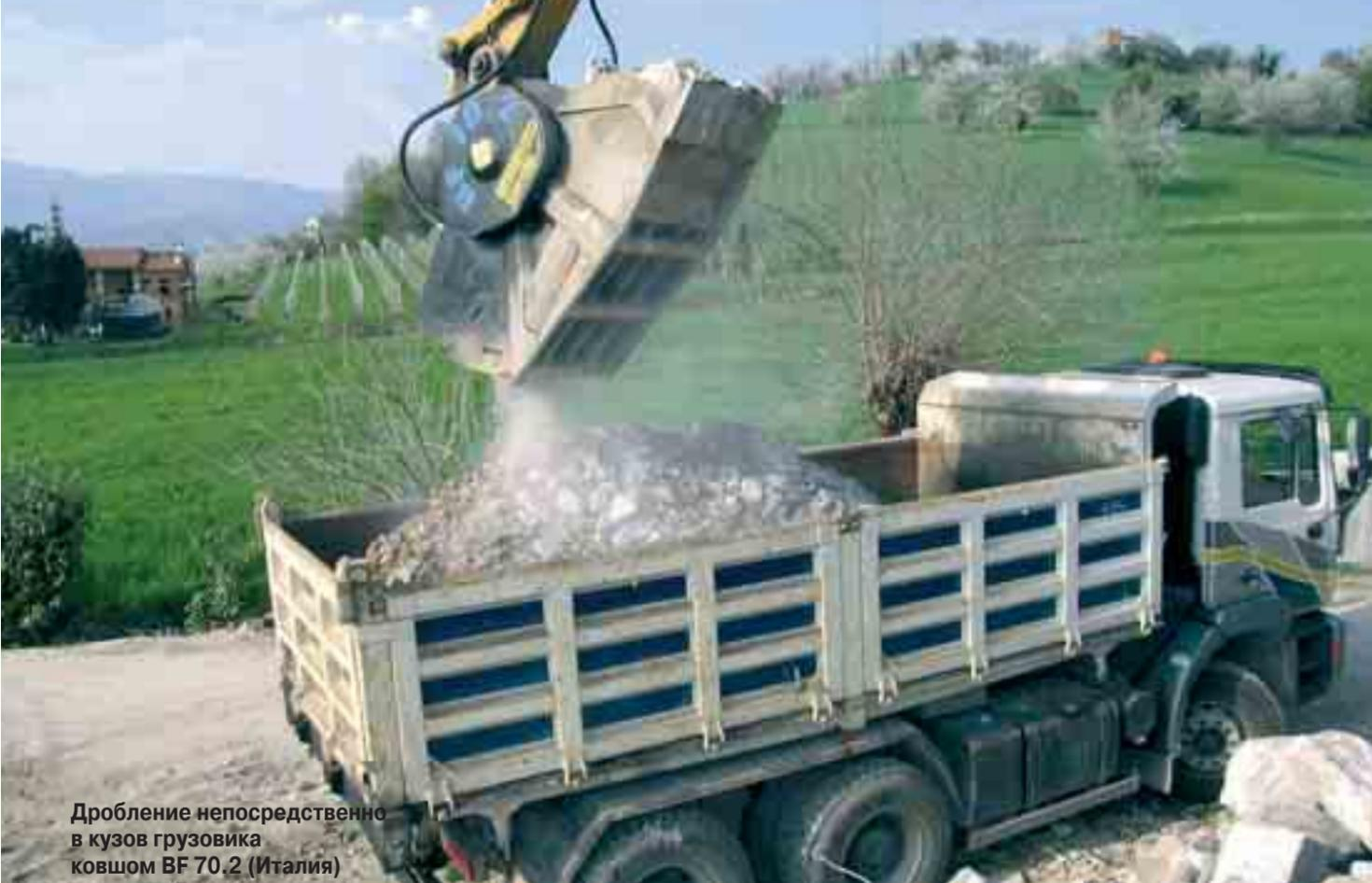
Дробление непосредственно в кузов грузовика ковшем BF 70.2 (Италия)
