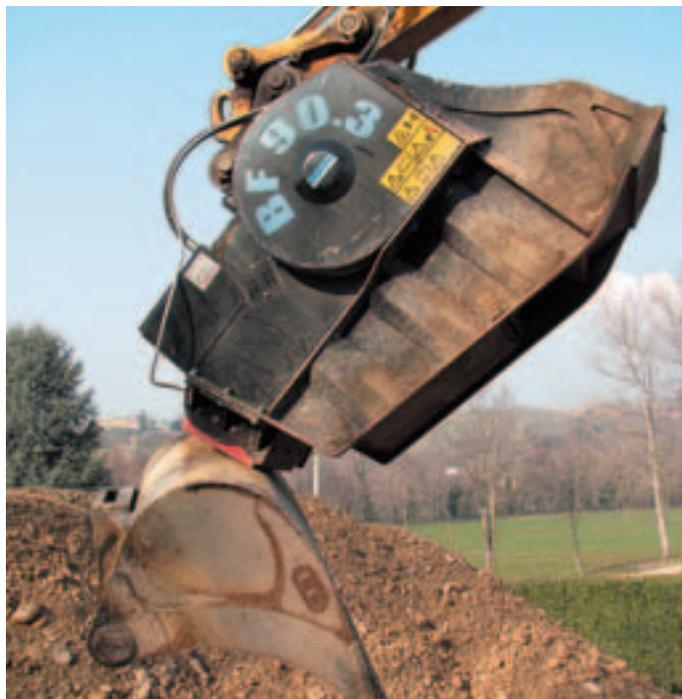
Электромагниты легко устанавливаются на весь ассортимент дробильных ковшей BF, а в комплект поставки входит все необходимое для их установки. Магнитное поле, которое создается в индуктивной катушке, настолько сильное, что дробильный ковш с таким магнитом в состоянии поднять простой ковш от экскаватора, что не раз демонстрировалось на выставке в Болоньи и вызывало у посетителей удивление.
