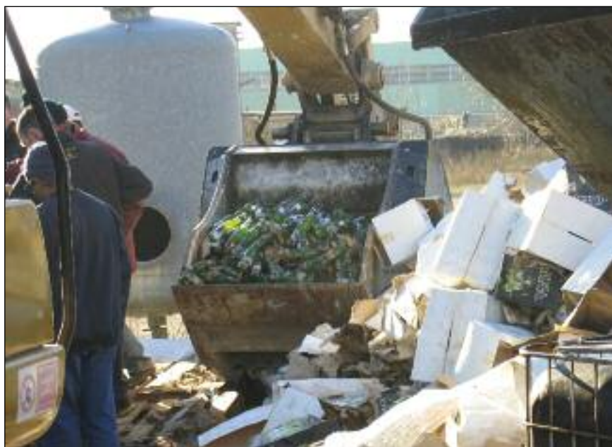
■ Raggiunta la capacità di 0,75 m 3 , la benna provvede alla frantumazione delle bottiglie sopra un cassone; il vino viene poi separato dal vetro tramite una pompa
