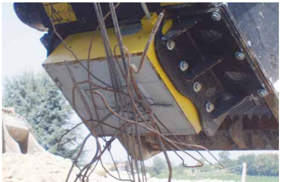
Nell'immagine sopra: il nuovo sistema di deferrizzazione MB consente la separazione del materiale ferroso dal materiale frantumato
