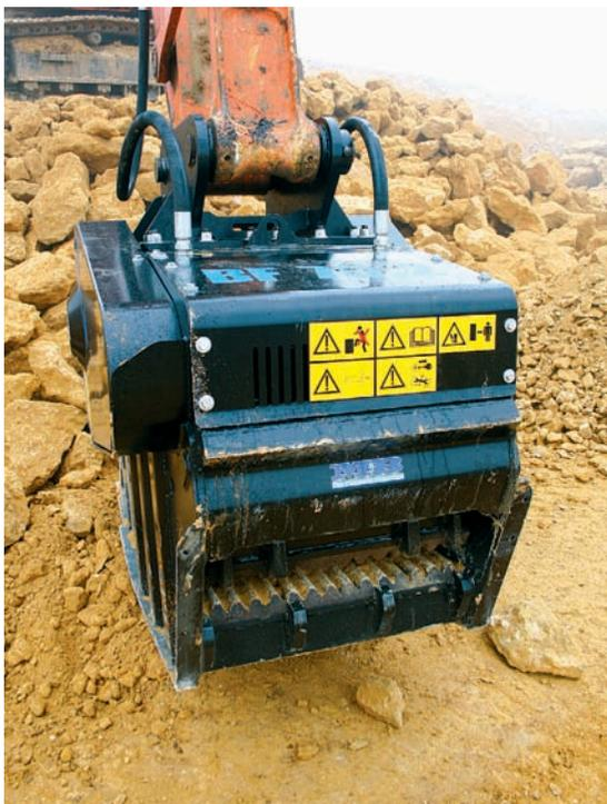
dell'escavatore e quindi ha proceduto alla misurazione e successiva taratura del flusso d'olio. In seguito, dopo aver sistemato la portata dell'impianto idraulico, Michele ha provveduto ad agganciare la benna all'escavatore sia meccanicamente, sia idraulicamente.
