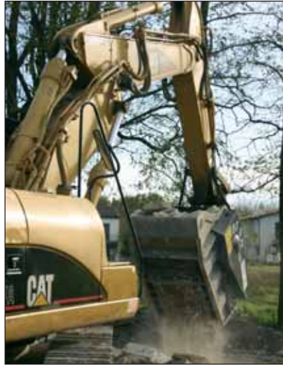
■ La particolare conformazione della bocca della benna evita l'incagliamento del materiale, facilitandone il carico The special conformation of the bucket mouth prevents the material jamming and so makes loading easier
