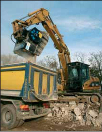
■ La BF 90.3 è un'attrezzatura della capacità di 0,75 m 3 per un peso di 3.500 kg The BF 90.3 attachment has a load capacity of 0.75 m 3 for a weight of 3,500 Kg
