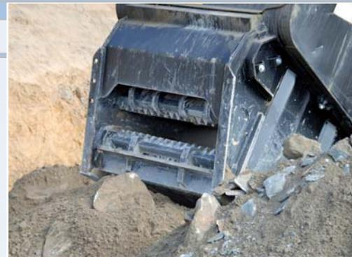
dieci minuti si può variare la pezzatura del materiale in uscita da 20 a 120 mm.
