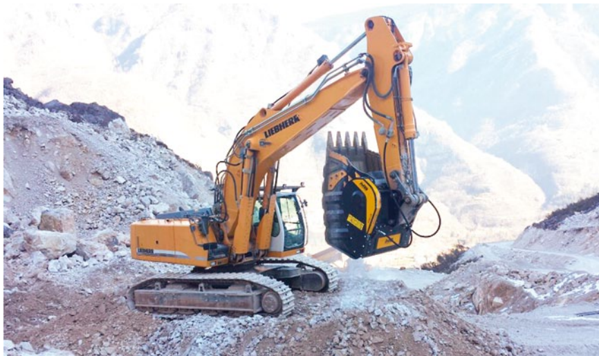
La cuchara trituradoras BF 135.8 es adecuada ser montada en excavadoras sobre 43 toneladas.
