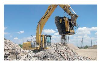
esde 2001, MB ofrece una amplia gama de cucharas trituradoras patentadas y accesorios, gracias a su constante innovación e investigación tecnológica, aplicables a excavadoras, cargadoras, minicargadores y retroexcavadoras de todos los tamaños.
