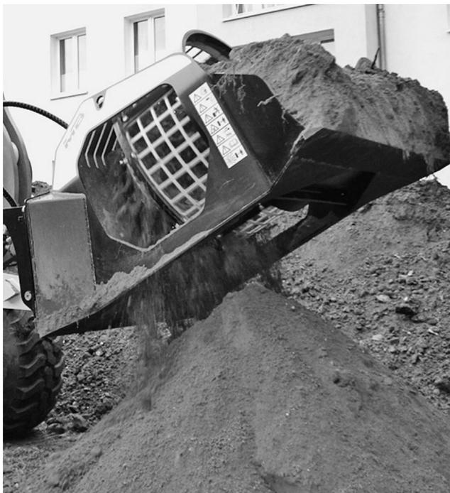
Um den anfallenden Erdaushub zur Aufarbeitung nicht mehr umständlich durch die Stadt fahren zu müssen, entschied sich die Firma Bauer aus Rostock zur Anschaffung einer hydraulischen Trommelsiebschaufel von MB. Foto: Bauer
