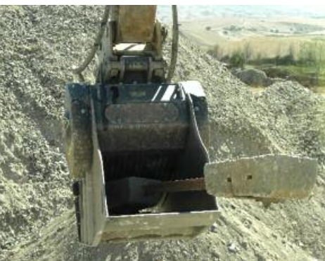
La nueva cuchara trituradora MB modelo BF70.2 adquirida por Excavaciones Guda Ávila S.L.
