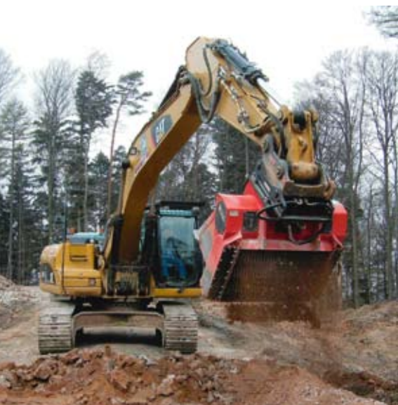
Schaufelseparator: Sieben, Mischen, Belüften, Zerkleinern und Laden in einem Arbeitsgang
