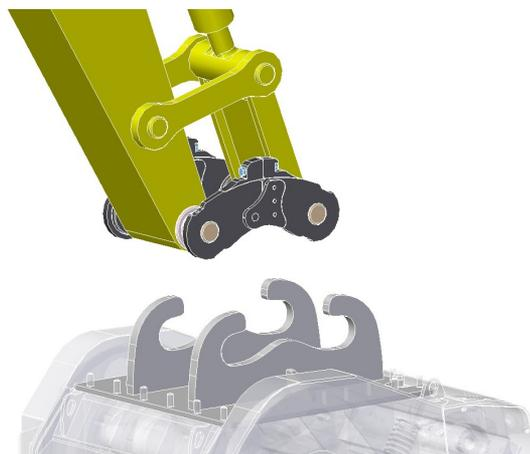
*Simulación gráfica de la conexión entre el enganche y la cuchara trituradora.*
