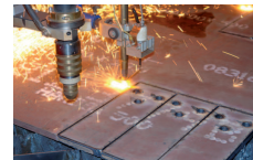
Hardox-Stahl kann nach Bedarf gebogen, gebohrt, geschnitten, geschweißt oder gefräst werden.
