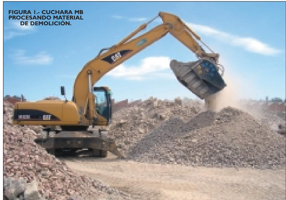
FIGURA 1.- CUCHARA MB PROCESANDO MATERIAL DE DEMOLICIÓN.
