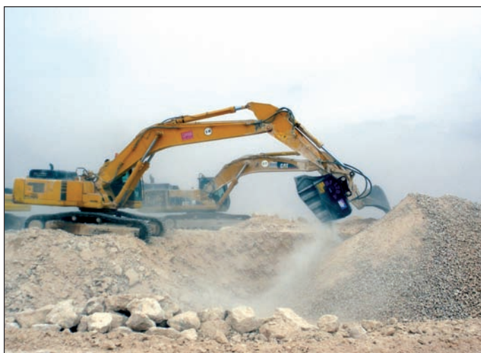
■ Las cucharas trituradoras MB aprovechan el sistema hidráulico de las excavadoras y reciclan el material inerte excavado.
