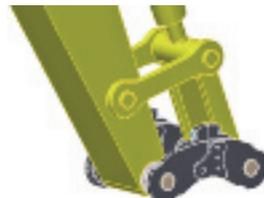
geniale, l'Attacco Rapido Universale, un'attrezzatura vincente che offre ai propri clienti la possibilità di un lavoro in cantiere il più agevolato possibile. Disponibile in sette modelli a seconda dell'escavatore e del perno su cui verrà montato, il nuovo Attacco Rapido Universale permette di connettere allo stesso escavatore qualsiasi
