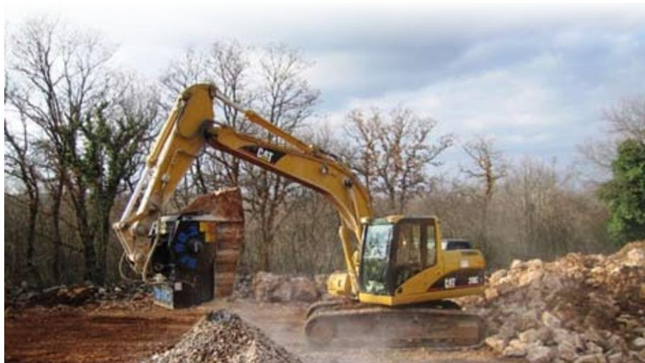
*Backenbrecherlöffel vom Typ 90,3 im Einsatz, dieser Löffel zerkleinert stündlich bis zu 50 t Material.*
