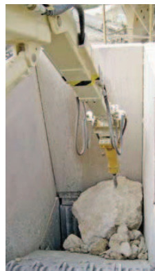
Die hydraulische Steuerung erfolgt mittels Funk- oder Kabelfernbedienung oder von einem stationären Pult.
