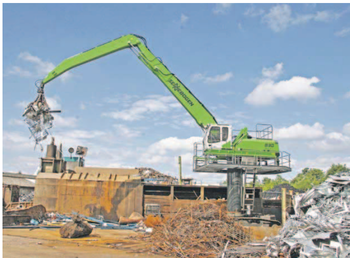
Der Sennebogen 830 Elektro mit 4 m Pylon arbeitet enorm wirtschaftlich und zuverlässig. 100 Prozent Leistung Non-Stop – 0 Liter Diesel.
