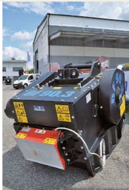
Betonarmierung und andere metallische Fremdkörper zieht dieser optional anbaubare Magnet aus dem Aufnahmegut, bevor es den eigentlichen Brechvorgang im Löffel stören könnte. Bei Anwendungen im Naturstein kommt man natürlich ohne dieses Hilfsmittel aus.
