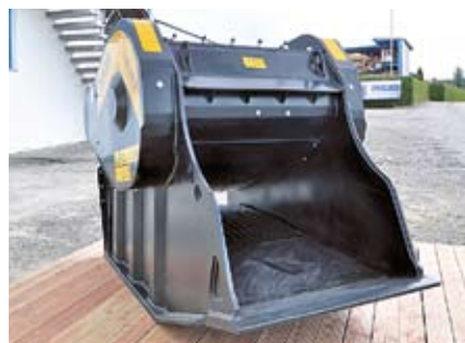
Mit neu gestalteter Brechkammer – unter anderem wurde der Winkel zwischen fester und beweglicher Brechbacke optimiert – bringt der Löffeltyp BF 90.3 S 2 deutlich mehr Durchsatz. Dank besserer Gewichtsverteilung passt er nun perfekt an 20 t schwere Grundgeräte.
