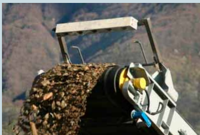
Der Messbalken ist am Ende des Förderbandes befestigt und misst dort mit Ultraschall die Höhe des beförderten Schüttgutes. | Foto: Teufelsmoor
