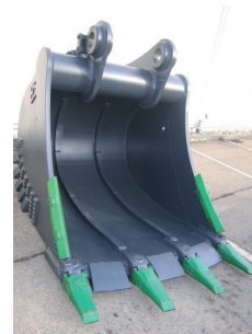
Zum Zertrümmern des Granits setzt die ProStein GmbH & Co. KG in Sachsen eine 4,5 Tonnen schwere Eisenkugel ein. HS-Schoch entwickelte hierfür diesen speziellen Felstiefelöffel.
