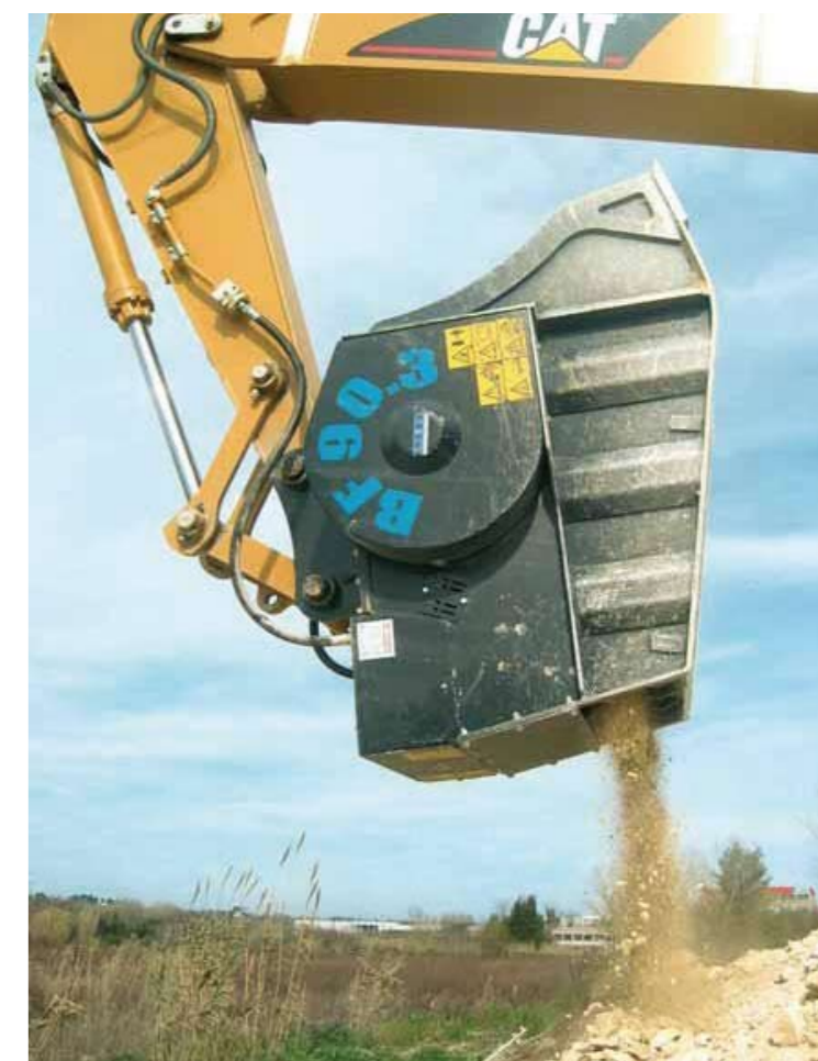
Benne frantoio all'opera: dall'alto, due esempi applicativi del modello BF90.3; a sinistra, la BF120.4 durante la frantumazione in un campo prove allestito in occasione del Saie 2007.
