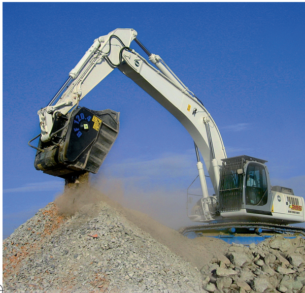
Der BF 120.4 mit einem Fassungsvermögen von 1 m 3 wiegt 4,9 t und wird für Bagger ab 28 t empfohlen. Gebrochen wird damit auf 20 bis 120 mm bei Durchsätzen zwischen 25 und 50 m 3 /h. Foto: MB
