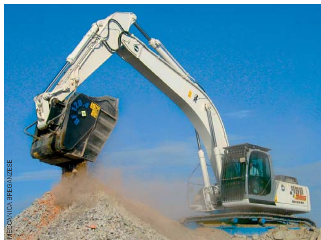
Der Backenbrecherlöffel BF 120,4 ist für Bagger ab 28 t geeignet.
