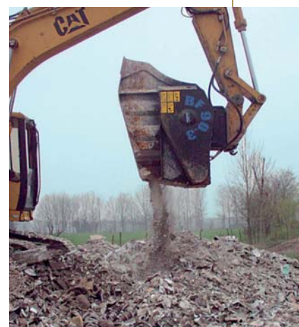
Der Backenbrecherlöffel BF 90,3 wird für Bagger ab 20 t empfohlen.
