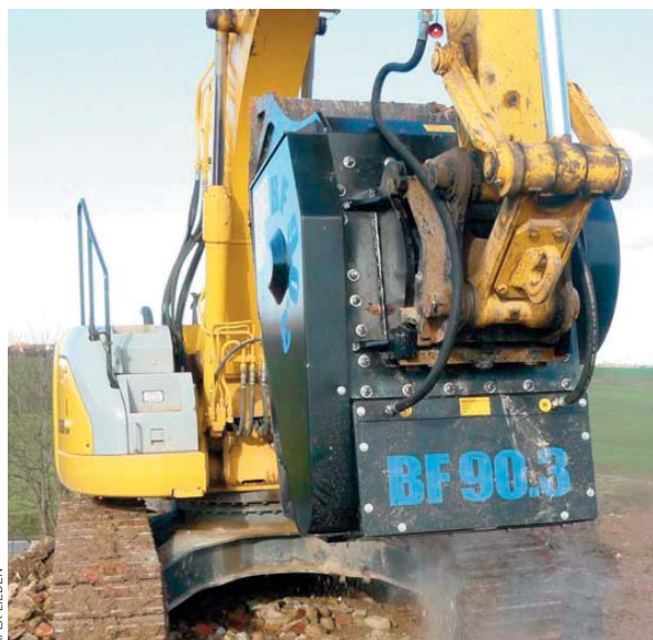
Baggerbrecherlöffel von MB als Alternative zu Mietbrechanlagen.
