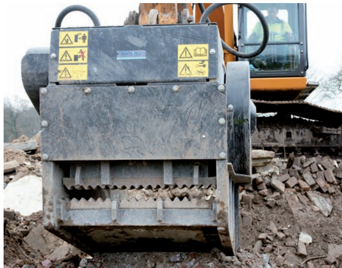
Met twee smerbare lagers en een vaste en een bewegende brekerplaat vraagt de EcoCrusher amper onderhoud.
